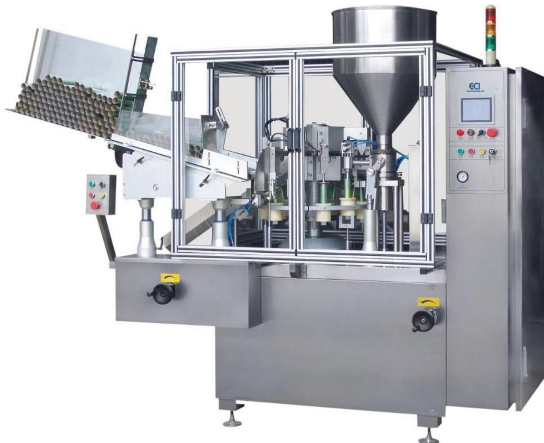
Автоматическая машина мод. **CCI 400** для наполнения и закрытия туб - современное технологичное упаковочное решение, в котором традиционный подход к процессу упаковки совмещен с новейшими технологиями и оснащением.
